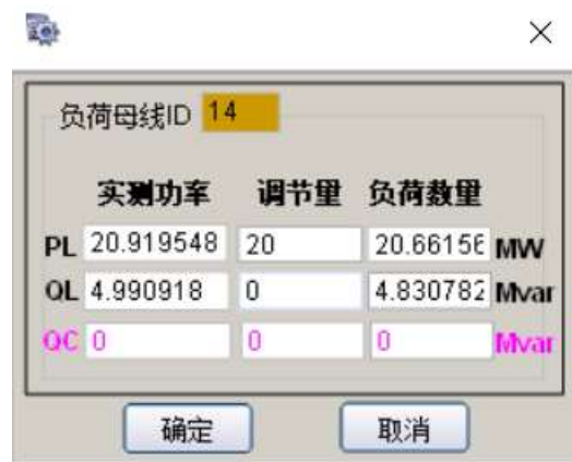
图 1.2: 右键点击负荷图标，弹出负荷调节界面，改变负荷大小，观察单机负荷系统的发电机一次调频过程
